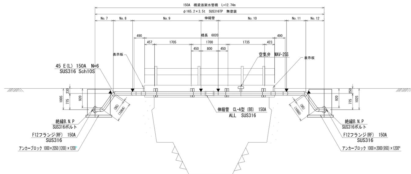
▲ : 現場溶接・現場X線検査箇所(1リング1枚) N=6
